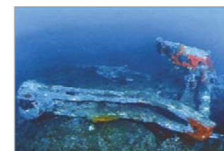
Il bilanciere in ferro che serviva a trasmettere il movimento alla biella collegata all'albero della grande ruota a pale
