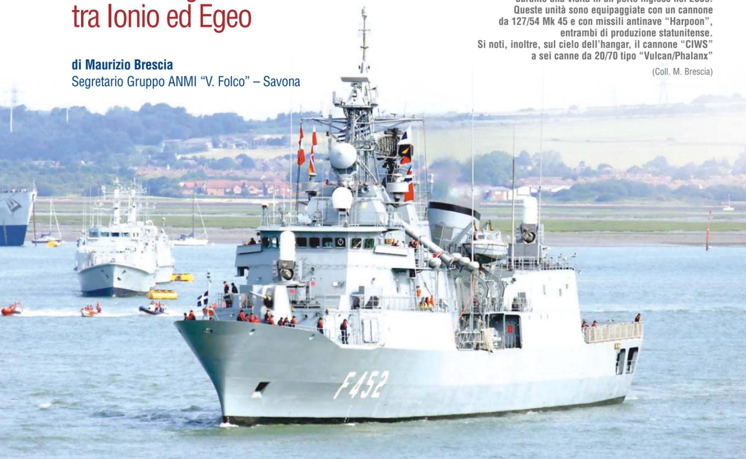
La fregata *Hydra*, del tipo "Meko 200", durante una visita in un porto inglese nel 2009. Queste unità sono equipaggiate con un cannone da 127/54 Mk 45 e con missili antinave "Harpoon", entrambi di produzione statunitense. Si noti, inoltre, sul cielo dell'hangar, il cannone "CIWS" a sei canne da 20/70 tipo "Vulcan/Phalanx"
