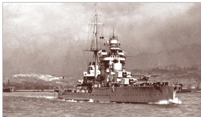
L'incrociatore pesante *Pola*, anch'esso in uscita da Genova il 30 maggio 1938. Si notino l'idrovolante *Ro.43* e le catene per l'impiego dei paramine ai due lati della prora
