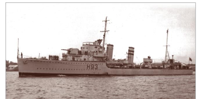
Portsmouth, dicembre 1936. Il cacciatorpediniere *Hereward* in una particolare configurazione "sperimentale": difatti, nella posizione "B", è stato installato il prototipo dell'impianto binato da 120/50 Mk XIX che costituirà l'armamento principale dei successivi, grossi caccia della classe "Tribal". Per non ridurre la stabilità, il cannone singolo da 120 mm della posizione "A" è stato sbarcato (Wright & Logan, coll. M. Brescia)
