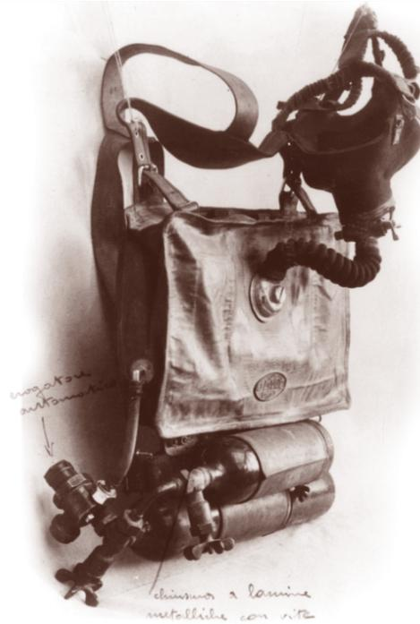
L'autorespiratore ad ossigeno ad autonomia ridotta con maschera ed occhiali separati modello I.A.C. (una consociata della Pirelli) 49/bis (Fototeca U.S.)
