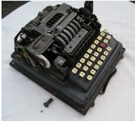
Adotta un meccanismo tipo Hagelin con rotori non cablati e differisce dalla M209 americana per la tastiera molto più pratica di tipo alfabetico (forze terrestri e navali) o numerica (forze aeronautiche), quest'ultima destinata principalmente alla trasmissione di messaggi codificati per le previsioni meteorologiche.
