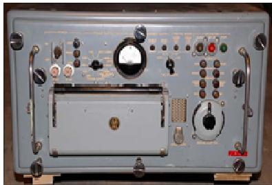
La catena di codifica e decodifica si basava su due componenti, la KWR-37 R (unità ricevente) e il KWT-37 T (unità trasmittente).
