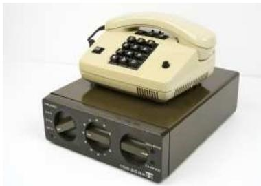
L'immagine mostra il TDS-2004 con l'apparato telefonico D-2000, versione modificata del Krone FeTAp 752, dotato di tastiera che non supportava la selezione a toni DTMF. I pulsanti permettevano il passaggio della conversazione da "in chiaro" (CL) a "crypto" (CR) a "privata" (P). L'interruttore Push-to-Talk (PTT) era utilizzato solo in modalità half-duplex.
