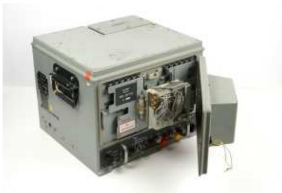
Alloggiata in un contenitore metallico a forma cubica, con tutte le connessioni sul retro e relativi controlli sul davanti, ospitava sul frontale il dispositivo di inserimento KYK-1 (cipolla) della chiave cifrante tramite dei penzoli.
