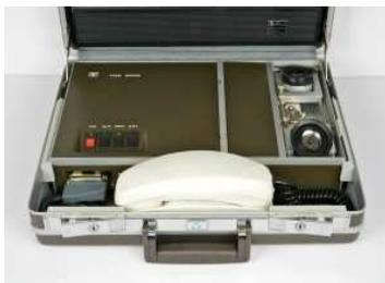
Collegabile direttamente ad una linea telefonica analogica (PSTN), nel caso in cui non fosse disponibile una linea diretta poteva essere utilizzato anche con l'accoppiatore acustico integrato e telefono esterno di interfaccia alla linea PTT.
