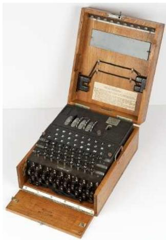
Dotata di quattro rotori operativi con incise 26 lettere (invece che numeri), di cui il primo a sinistra non era mobile nelle fasi di codifica/decodifica e il suo posizionamento in "A" determinava la perfetta compatibilità di M4 con le macchine standard M3 o tipo I in uso presso le forze armate tedesche.
