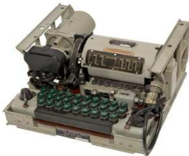
Presenta una tastiera intelligente, progettata con un bordo permutatore scorrevole, un interruttore complesso necessario per cambiare la direzione del segnale attraverso il gruppo rotore e tubi a vuoto per il controllo dei segnali di temporizzazione del sistema della stampante.
