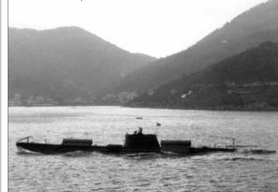
Lo Scirè in uscita dalla base Navale di La Spezia, agli inizi del 1941. Ben visibili i cilindri contenitori degli SLC (Siluri a Lenta Corsa), i mezzi d'assalto subacquei della Decima MAS"
